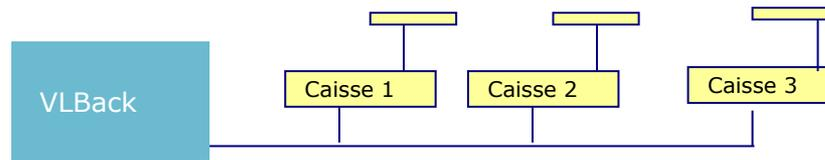
Connexion réseau entre le poste PC back-office et les caisses.
